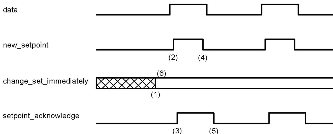
Les schémas montrent la différence entre le mode de jeu de valeurs de consigne (`set_of_setpoints`) et le mode de valeur de consigne unique. L'état initial du bit `change_set_immediately` dans le mot de contrôle détermine le mode utilisé. Pour que ces exemples restent simples, seuls des mouvements trapézoïdaux sont utilisés.
