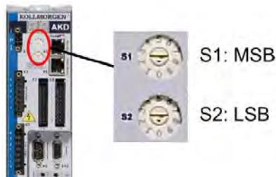
Les commutateurs rotatifs du variateur AKD (S1 et S2) correspondent à l'adresse du nœud CAN. Les commutateurs S1 et S2 correspondent également à la configuration de l'adresse IP du variateur. Les schémas d'adresse réseau CAN et IP doivent être configurés pour représenter cette dépendance si les deux réseaux TCP/IP et CAN sont exécutés simultanément dans une application.
