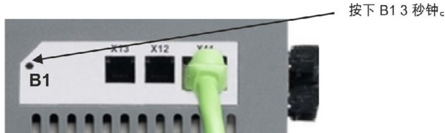
4. 当显示屏闪烁显示所设置的旋转开关设定值时，松开按钮 **B1**，并耐心等待直到不再闪烁为止。在此期间，参数 **FBUS.PARAM01** 将被设置为新值，且会将所有参数存储到非易失闪存中。下次启动驱动器时会采用新设置。
