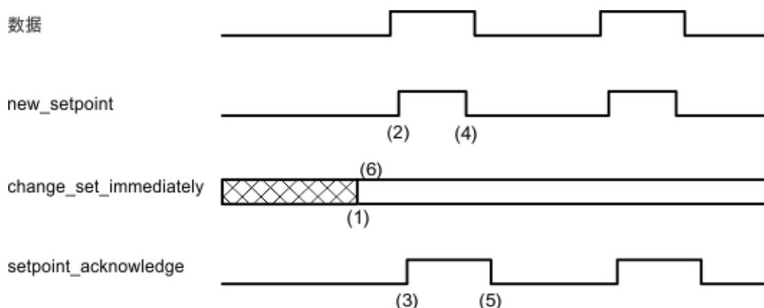
这些图形显示设定点集模式和单个设定点模式之间的区别。控制字中位change\_set\_immediately的初始状态决定使用的模式。为使这些示例简单明了，仅使用了梯形位移。
