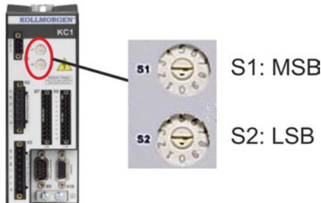
KC1 (S1&S2) 前面的旋转开关对应于 CAN 节点地址。
