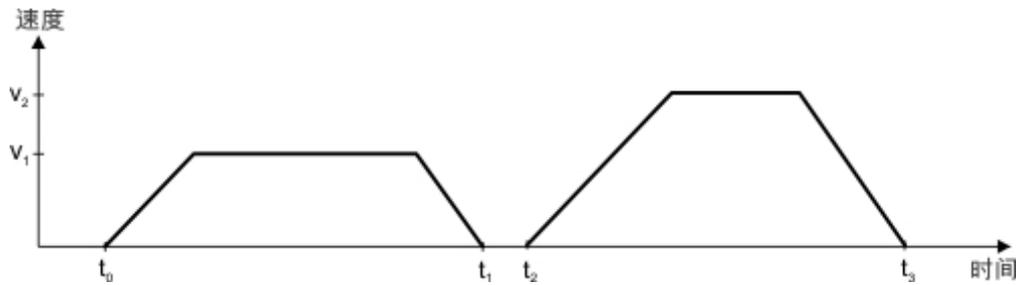
将change\_set\_immediately设置为“1”(6), 主机指示驱动器在达到前一个设定点之后立即应用新的设定点。其他的信号的相对时序不改变。此行为导致驱动器提前处理下一个设定点X2, 且在t1时达到target\_positionX1时保持它的速度。此时，驱动器立即移动到下一个已经计算好的target\_positionX2。
