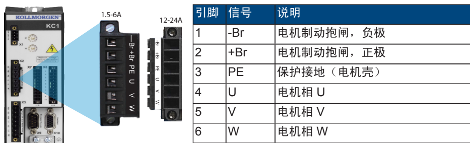
图 4. 接线端子 X2，KC1-xxxx06
