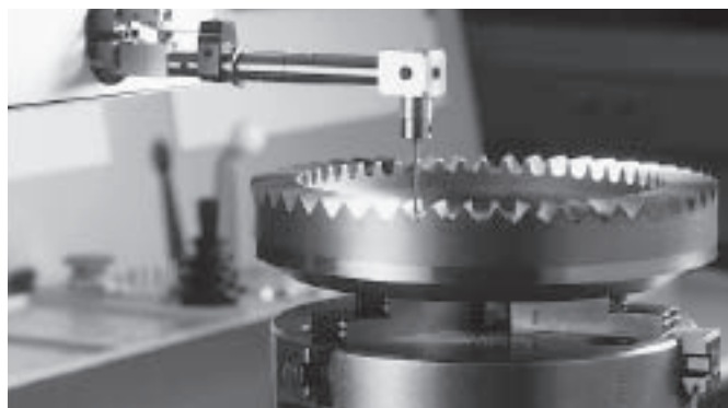
Mappatura computerizzata del profilo dei denti della ruota
