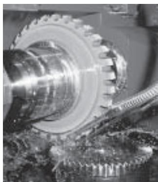
Lavorazione degli ingranaggi ortogonali PowerTRUE™ con macchinari a controllo numerico computerizzato
