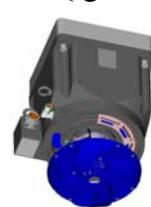
用螺丝刀拧开盘头螺钉 (C(H)09有8个，C(H)13有12个)，移开蓝色盖子。
