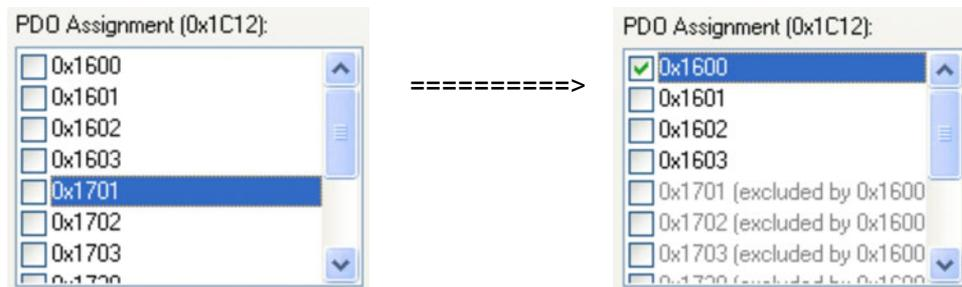
Anschließend können Sie das Standard-Mapping, z.B. für PDO 0x1600, erweitern:
