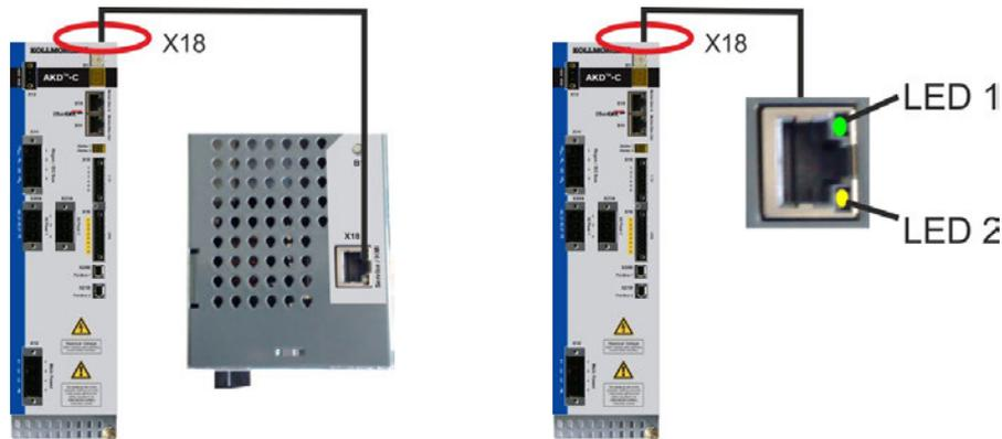
Schließen Sie die Serviceschnittstelle (X18) an eine Ethernet-Schnittstelle am PC direkt oder über einen Netzwerkschwitch an. Das Kabel kann auch bei eingeschalteter Spannung gesteckt werden. Prüfen Sie, ob die Verbindungs-LEDs am AKD-C (grüne LED am RJ45-Stecker) und an Ihrem PC (oder Netzwerkschwitch) beide leuchten. Wenn beide LEDs leuchten, besteht eine gute elektrische Verbindung.
