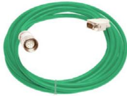
Alle Standardmotoren unseres Programms haben den gleichen, 12-poligen Stecker für den Resolveranschluss. Über diesen Stecker werden auch die Anschlüsse des Thermoschutzkontakts im Motor zum Servoverstärker geführt. Die Servoverstärker haben eine Sub-D Buchse zum Anschluss eines Resolvers und des Thermoschutzes.
