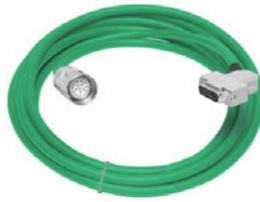
Alle Standardmotoren unseres Programms haben den gleichen, 17-poligen Stecker für den ComCoder Anschluss. Über diesen Stecker werden auch die Anschlüsse des Thermoschutzes im Motor zum Servoverstärker geführt. Die Servoverstärker haben eine Sub-D Buchse zum Anschluss von ComCoder und Thermoschutz. Die Abschirmung der Leitung wird über das Steckergehäuse mit dem Servoverstärker verbunden. Das Motorfeedback sollte mit den konfektionieren Leitungen von Kollmorgen angeschlossen werden. .
