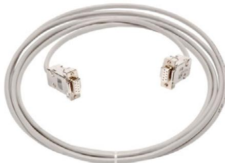
Zur Parametrierung und für Firmware-Upgrades können die Servoverstärker mit der seriellen RS232 Schnittstelle eines PC verbunden werden. Die Verbindungsleitung muss abgeschirmt sein. Das Schirmgeflecht der RS232-Verbindungsleitung wird über das Steckergehäuse des Sub-D Steckers mit der Frontplatte des Servoverstärkers leitend verbunden.
