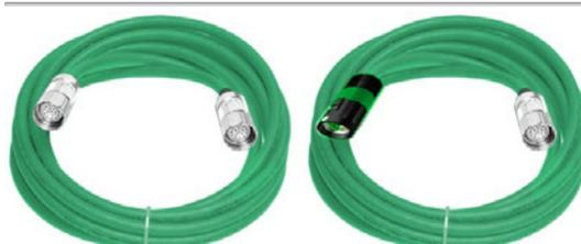
Die AKD-N Servoverstärker haben einen Rundstecker zum Anschluss eines Encoder Feedbacks und des Thermoschutzes. Auf der Motorseite sind zwei Steckertypen möglich: standard Kollmorgen IP65 oder y-tec Stecker für AKM1. Maximale Leitungslänge 5 m. Die Abschirmung der Leitung wird über das Steckergehäuse mit dem AKD-N verbunden.
