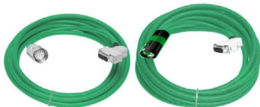
Die AKD-B/P/T/M Servoverstärker haben eine 15polige HD Sub-D Buchse zum Anschluss von Encoder und Thermoschutz. Auf der Motorseite sind zwei Steckertypen möglich: standard Kollmorgen IP65 oder y-tec Stecker für AKM1. Maximale Leitungslänge ist 50 m. Die Abschirmung der Leitung wird über das Steckergehäuse mit dem AKD-B/P/T/M verbunden.
