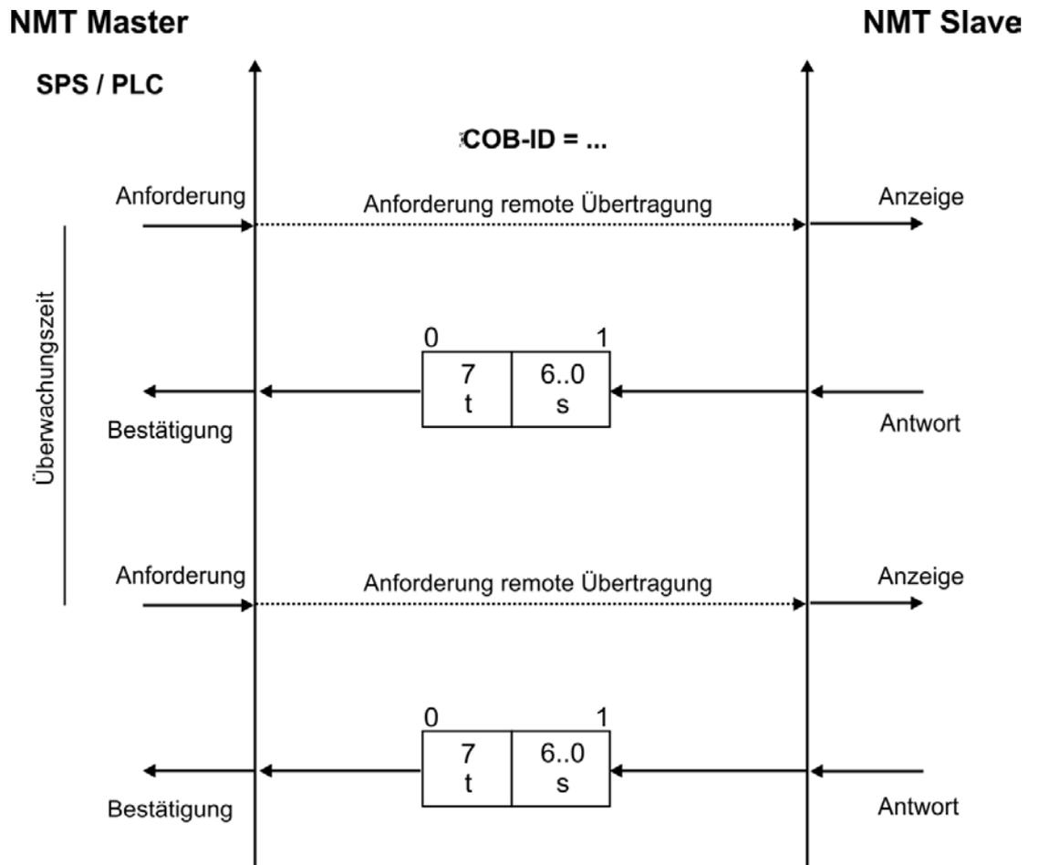
t = Umschalt-Bit, ändert seinen Zustand mit jedem Slave-Telegramm
