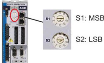
Die Drehschalter an der Frontplatte des AKD (S1 & S2) entsprechen der CAN- Stationsadresse. Die Schalter S1 & S2 entsprechen auch der IP-Adresseneinstellung des Verstärkers. Sowohl das CAN- als auch das IP-Netzwerkadressenschema müssen konfiguriert werden, um dieser Abhängigkeit Rechnung zu tragen, wenn das TCP/IP- und das CAN-Netzwerk in einer Anwendung gleichzeitig ausgeführt werden.
