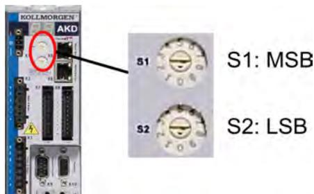
Les commutateurs rotatifs du variateur AKD (S1 et S2) correspondent à l'adresse du nœud CAN. Les commutateurs S1 et S2 correspondent également à la configuration de l'adresse IP du variateur. Les schémas d'adresse réseau CAN et IP doivent être configurés pour représenter cette dépendance si les deux réseaux TCP/IP et CAN sont exécutés simultanément dans une application.
