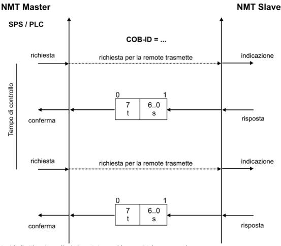
t = bit di attivazione, il relativo stato cambia a ogni telegramma slave
