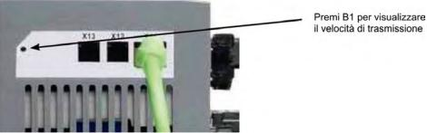
3. quando il display lampeggia con l'impostazione del selettore rotativo, interrompere la pressione sul pulsante B1 e attendere che il lampeggio termini. Durante questo periodo il parametro FBUS.PARAM01 viene impostato al nuovo valore e tutti i parametri vengono memorizzati nella memoria non volatile. La nuova impostazione sarà acquisita all'accensione successiva del servoamplificatore.
