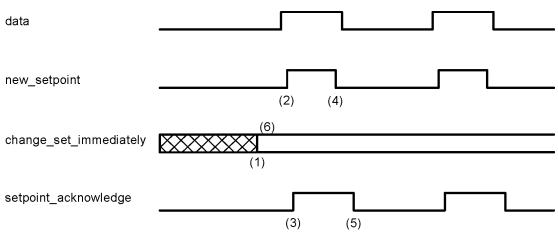
Le immagini mostrano la differenza tra la modalità set\_of\_setpoints e la modalità setpoint singolo. Lo stato iniziale del bit change\_set\_immediately nella parola di controllo determina quale modalità è utilizzata. Per semplificare questi esempi, sono utilizzati solo i movimenti trapezoidali.
