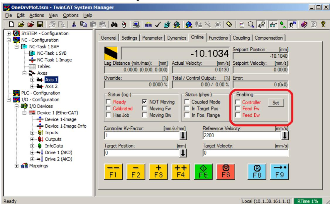
3. Im Popup-Dialogfenster das Kontrollkästchen Controller aktivieren, um den Servoverstärker freizugeben (bzw. die Aktivierung aufheben, um den Servoverstärker zu sperren), und mit OK bestätigen.
