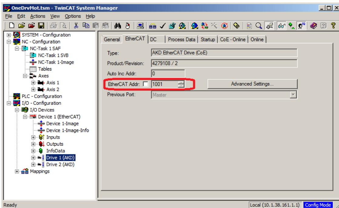
Die Netz-ID kann in der Registerkarte EtherCAT unter I/O Configuration → I/O Devices → Device [x] abgerufen werden.
