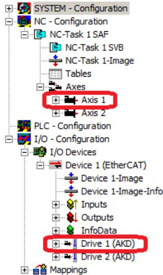
Zum Anschluss an die Servoverstärker über WorkBench müssen sich diese im Zustand Pre-Op, Safe-Op oder Op befinden. Der Zugriff auf die Statusmaschine für einen Servoverstärker kann über die Registerkarte Online für den entsprechenden Servoverstärker unter dem Knoten I/O Configuration → I/O Devices → Device [x] → Drive [x] erfolgen (siehe Screenshot unten).
