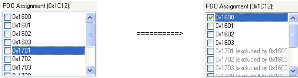
Anschließend können Sie das Standard-Mapping, z.B. für PDO 0x1600, erweitern:
