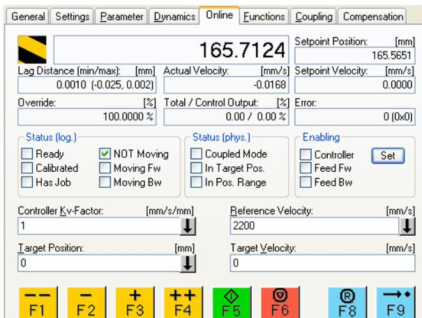
Nach Aktivierung der Leistungsstufe über die Schaltfläche „All“ kann der Verstärker über die Bewegungsschaltflächen oder die Funktionen im Funktionsmenü bewegt werden.
