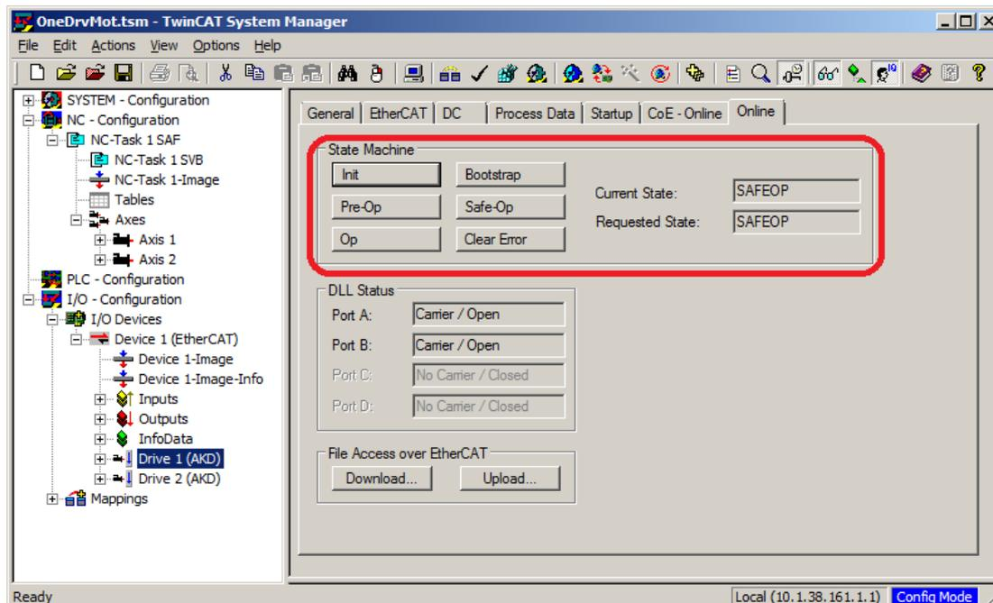
Das Installationsverfahren für WorkBench entspricht dem üblichen Verfahren. Ausnahme: WorkBench muss in derselben Maschine installiert werden wie TwinCAT. Die Kommunikation mit dem Servoverstärker erfolgt über den TwinCAT-Master. WorkBench kann nicht dezentral an den Master angeschlossen werden.
