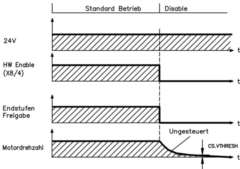
Wenn die Geschwindigkeit unter den Schwellenwert *CS.VTHRESH* abfällt oder es zu einer Zeitüberschreitung kommt, wird die Bremse geschlossen (=> p. 94).
