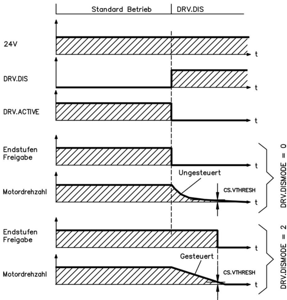
Wenn die Geschwindigkeit unter den Schwellenwert *CS.VTHRESH* abfällt oder es zu einer Zeitüberschreitung kommt, wird die Bremse geschlossen (=> p. 94).
