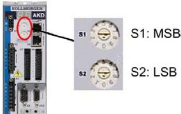
Die Drehschalter an der Frontplatte des AKD (S1 & S2) entsprechen der CAN-Stationsadresse. Die Schalter S1 & S2 entsprechen auch der IP-Adresseneinstellung des Verstärkers. Sowohl das CAN- als auch das IP-Netzwerkadressenschema müssen konfiguriert werden, um dieser Abhängigkeit Rechnung zu tragen, wenn das TCP/IP- und das CAN-Netzwerk in einer Anwendung gleichzeitig ausgeführt werden.
