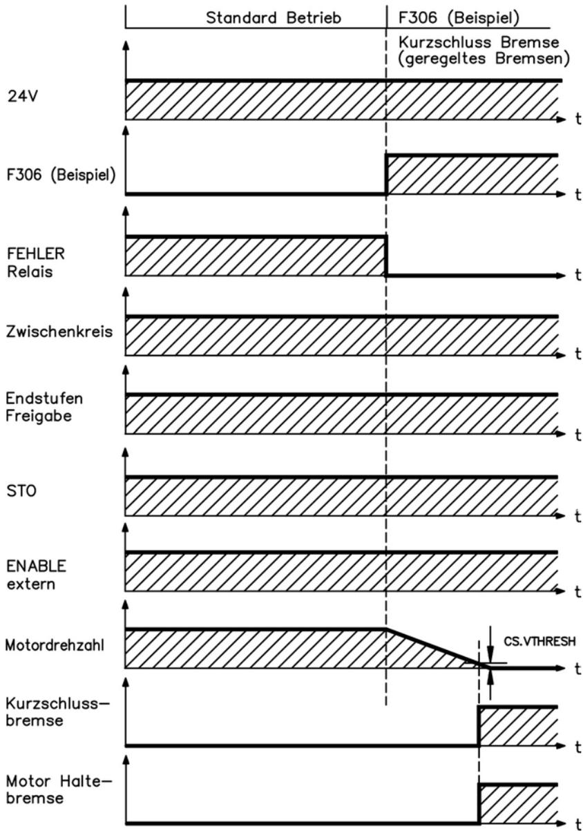
Wenn die Geschwindigkeit unter den Schwellenwert *CS.VTHRESH* abfällt oder es zu einer Zeitüberschreitung kommt, wird die Bremse geschlossen (=> p. 94).
