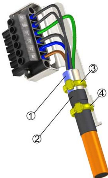
Isolieren Sie die äußere Kabelummantelung auf eine Länge von ca. 120 mm ab und achten Sie darauf, das Schirmgeflecht nicht zu beschädigen. Schieben Sie das Schirmgeflecht (1) über das Kabel und sichern Sie es mit einer Gummihülse (2) oder Schrumpfschlauch.
