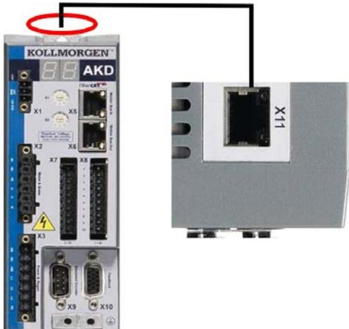
Schließen Sie die Serviceschnittstelle (X11) des Verstärkers an eine Ethernet-Schnittstelle am PC direkt oder über einen Netzwerkhub/-switch an, **während die Stromversorgung zu den Geräten abgeschaltet ist**. Verwenden Sie bevorzugt Standard-Ethernetkabel der Kategorie 5. Prüfen Sie, ob die Verbindungs-LEDs am AKD Verstärker (grüne LED am RJ45-Stecker) und an Ihrem PC (oder Netzwerkhub/-switch) beide leuchten. Wenn beide LEDs leuchten, ist eine ordnungsgemäße elektrische Verbindung hergestellt.
