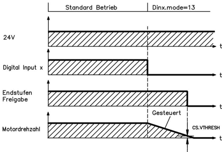
Wenn die Geschwindigkeit unter den Schwellenwert *CS.VTHRESH* abfällt oder es zu einer Zeitüberschreitung kommt, wird die Bremse geschlossen (=> p. 94).
