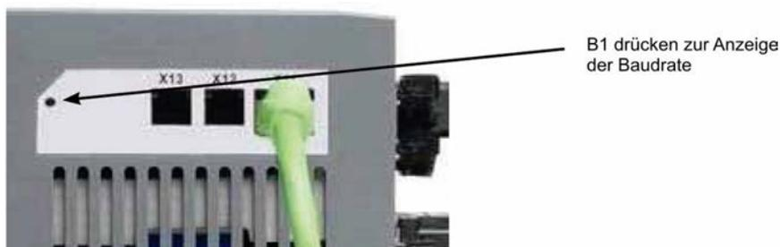
3. Wenn der Einstellwert des Drehschalters im Display blinkt, lassen Sie die Taste B1 los und warten Sie, bis das Blinken aufhört. Währenddessen wird der Parameter FBUS.PARAM01 auf den neuen Wert gesetzt, und alle Parameter werden im nichtflüchtigen Speicher gespeichert. Die neue Einstellung wird mit dem nächsten Einschalten des Servoverstärkers wirksam.
