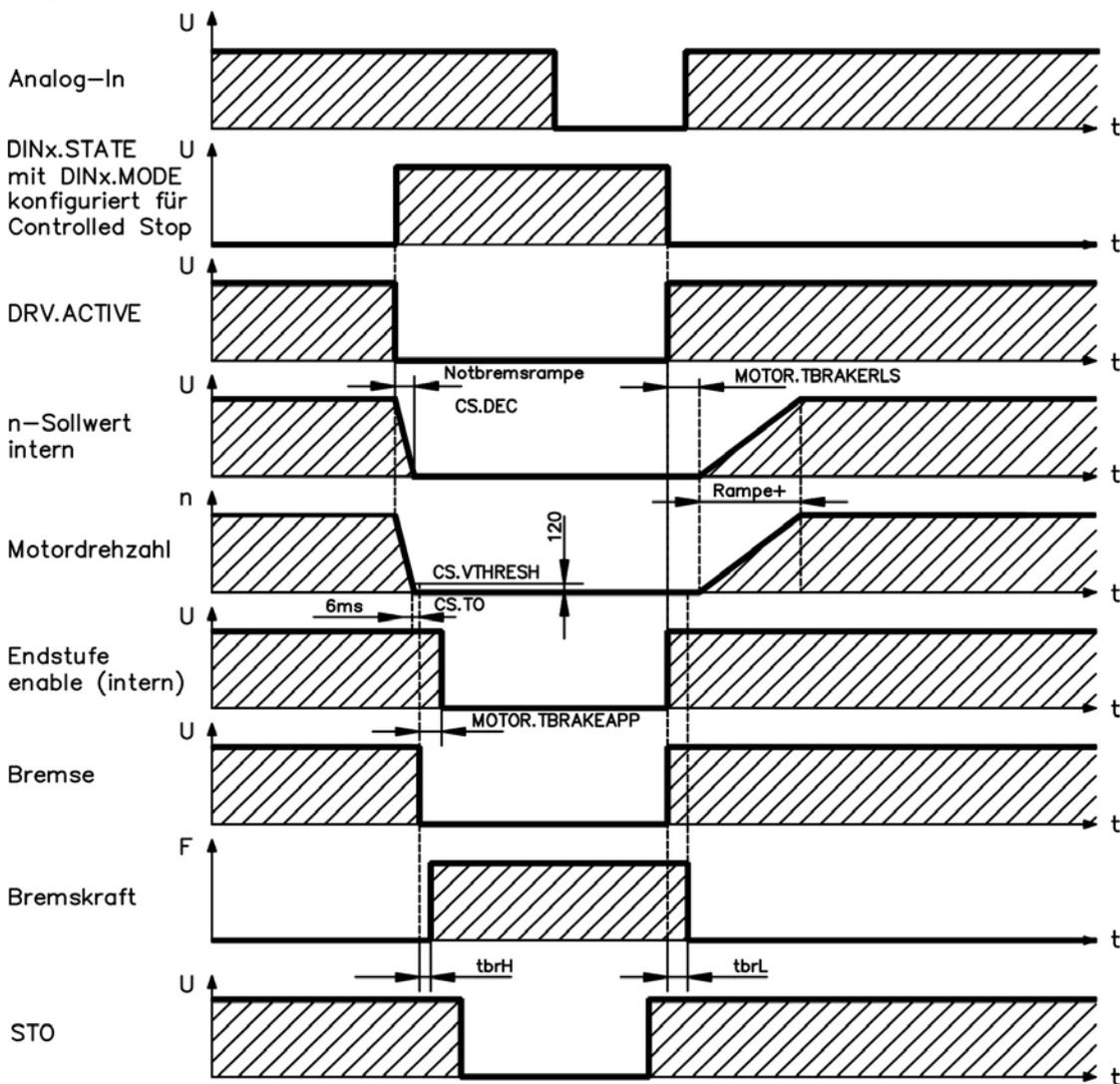
Der Geschwindigkeits-Sollwert des Verstärkers wird intern über eine einstellbare Rampe (CS.DEC) bis 0 V hinuntergeregelt. Mit Default-Einstellung wird der Ausgang für die Bremse geschaltet, wenn die Geschwindigkeit mindestens 6 ms (CS.TO) lang 120 U/min erreicht hat (CS.VTHRESH). Die Anzugszeiten ( $t_{brH}$ ) und Abfallzeiten ( $t_{brL}$ ) der in den Motor integrierten Haltebremse variieren je nach dem Motortyp (siehe Motorhandbuch).
