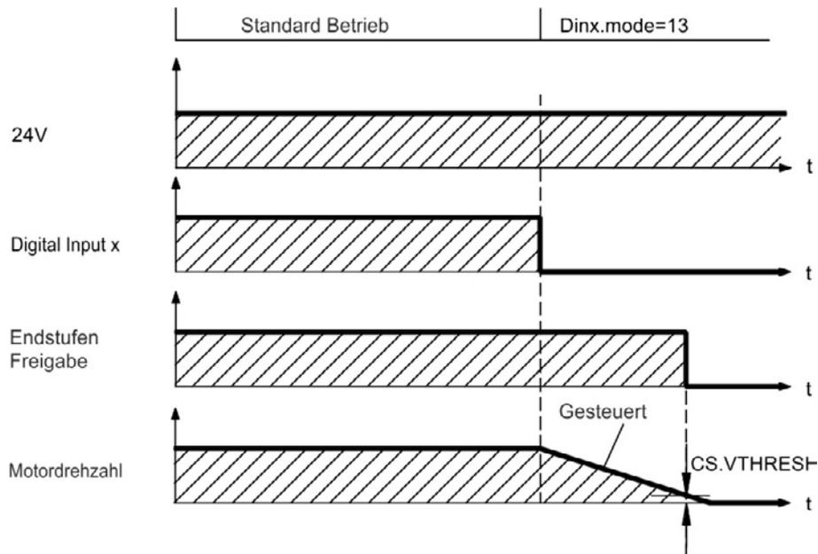
Wenn die Geschwindigkeit unter den Schwellenwert *CS.VTHRESH* abfällt oder es zu einer Zeitüberschreitung kommt, wird die Motorhaltebremse geschlossen (=> S. 98).
