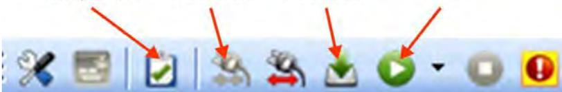
Doppelklicken Sie aus EtherCAT im Projekt Fenster zum Öffnen des EtherCAT Fensters. Klicken auf **SCAN Devices** startet die automatische Identifizierung und Auflistung Ihres AKD PDMM. Wenn mehrere AKD PDMM entdeckt wurden, kann ein bestimmter AKD PDMM mit einer der folgenden Methoden identifiziert werden:
