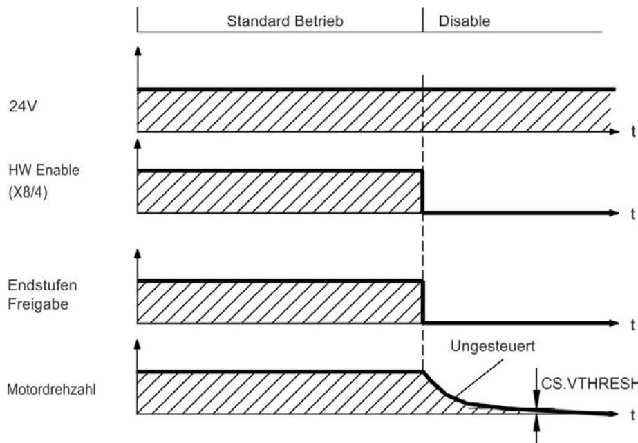
Wenn die Geschwindigkeit unter den Schwellenwert *CS.VTHRESH* abfällt oder es zu einer Zeitüberschreitung kommt, wird die Motorhaltebremse geschlossen (=> S. 98).
