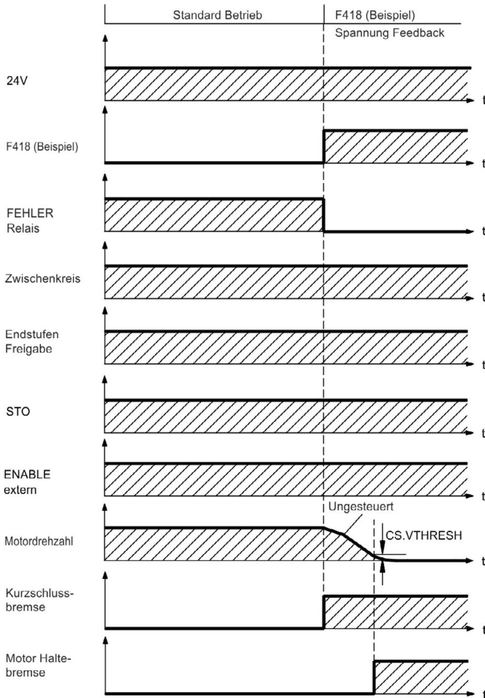
Wenn die Geschwindigkeit unter den Schwellenwert  $CS.VTHRESH$  abfällt oder es zu einer Zeitüberschreitung kommt, wird die Motorhaltebremse geschlossen (=> S. 98).
