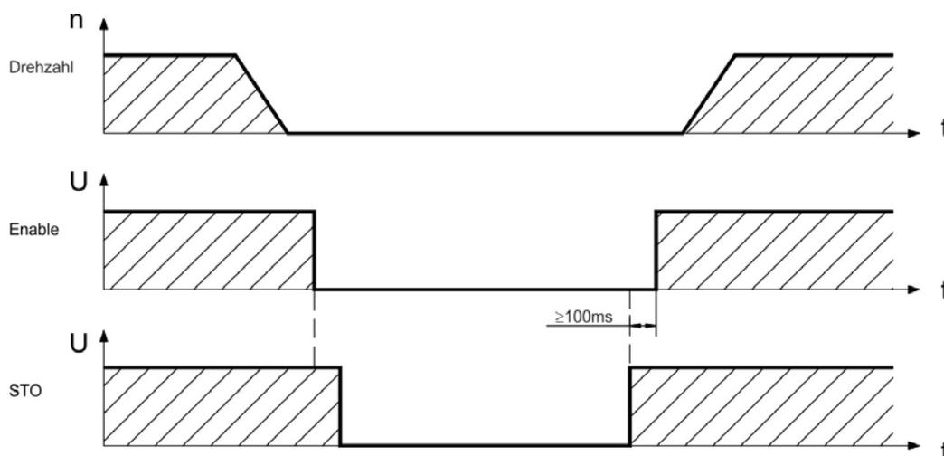
**⚠ WARNUNG** Hängende Lasten können sich bei Motoren ohne Bremse selbst in Bewegung versetzen, da der Motor bei aktivierter STO Funktion kein Drehmoment mehr erzeugt. Verwenden Sie Motoren mit einer integrierten, sicheren Haltebremse.
