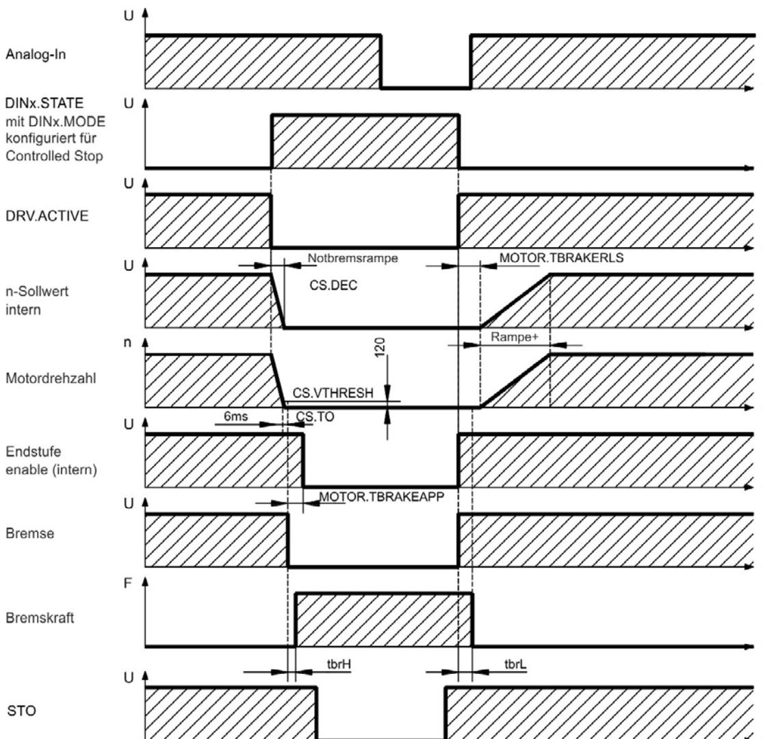
Der Geschwindigkeits-Sollwert des Verstärkers wird intern über eine einstellbare Rampe (CS.DEC) bis 0 V hinuntergeregelt. Mit Default-Einstellung wird der Ausgang für die Bremse geschaltet, wenn die Geschwindigkeit mindestens 6 ms (CS.TO) lang 120 U/min erreicht hat (CS.VTHRESH). Die Anzugszeiten ( $t_{brH}$ ) und Abfallzeiten ( $t_{brL}$ ) der in den Motor integrierten Haldebremse variieren je nach dem Motortyp (siehe Motorhandbuch).
