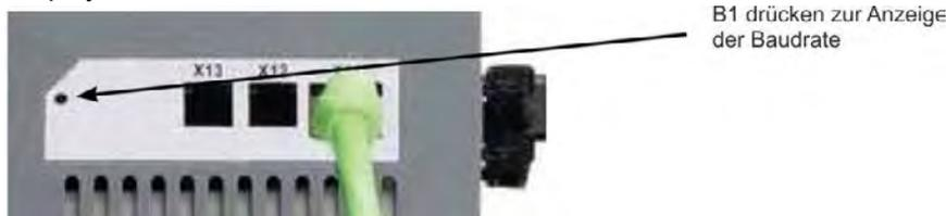
3. Wenn der Einstellwert des Drehschalters im Display blinkt, lassen Sie die Taste B1 los und warten Sie, bis das Blinken aufhört. Währenddessen wird der Parameter FBUS.PARAM01 auf den neuen Wert gesetzt, und alle Parameter werden im nichtflüchtigen Speicher gespeichert. Die neue Einstellung wird mit dem nächsten Einschalten des Servoverstärkers wirksam.
