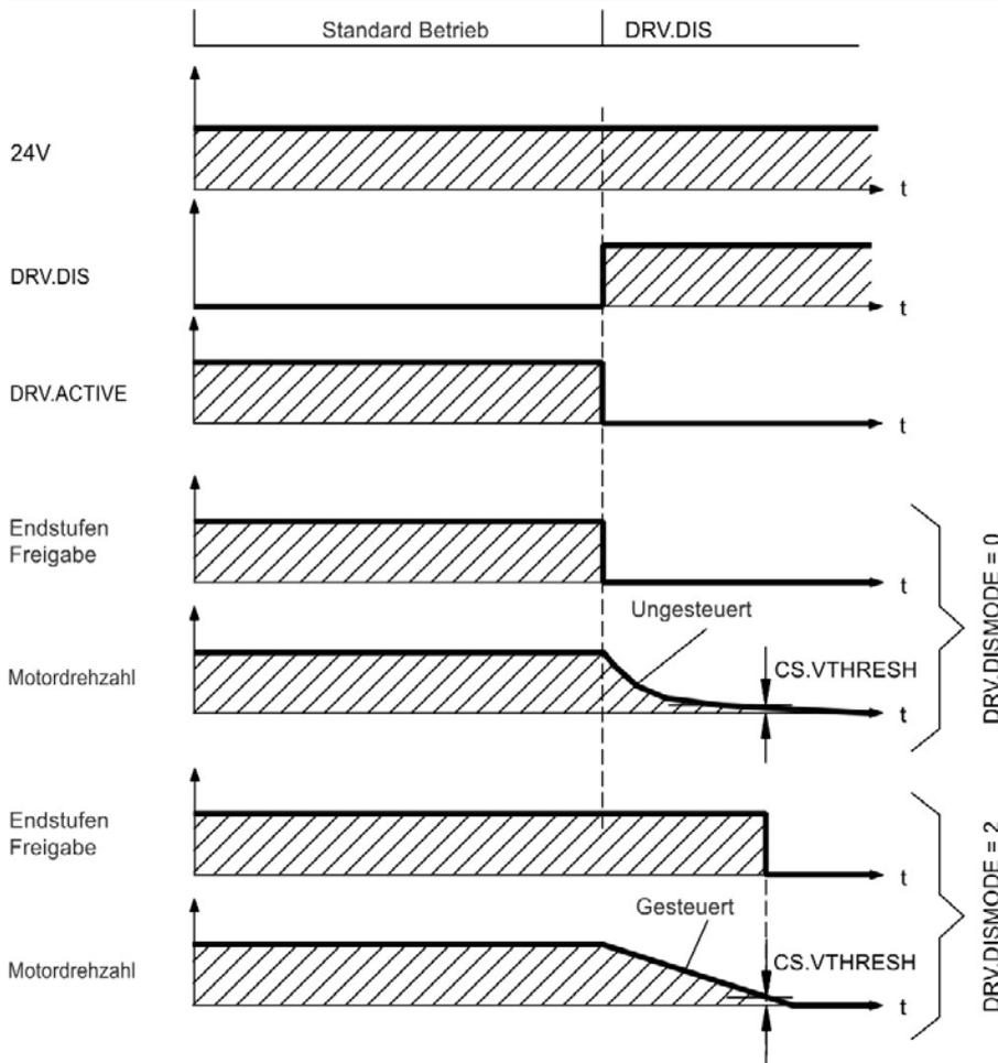
Wenn die Geschwindigkeit unter den Schwellenwert *CS.VTHRESH* abfällt oder es zu einer Zeitüberschreitung kommt, wird die Motorhaltebremse geschlossen (=> S. 98).
