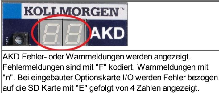
In der zweistelligen LED-Anzeige wird links ein „F“ oder „E“ für einen Fehler oder ein „n“ für eine Warnmeldung angezeigt. Rechts wird die Nummer des Fehlers oder der Warnung angezeigt: 1-0-1-[Pause]. Es wird der Fehler mit der höchsten Priorität angezeigt, wenn mehrere Fehler gleichzeitig vorliegen. Prüfen Sie den Fehlerbildschirm der Inbetriebnahmesoftware oder lesen Sie den Status von DRV.FAULTS, um die vollständige Liste der aktuellen Fehler anzuzeigen.
