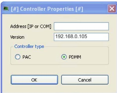
Geben Sie die IP Adresse des AKD PDMM ein, setzen Sie den **Controller Type** auf PDMM und klicken Sie auf OK. Um die Verbindung zum AKD PDMM herzustellen, benutzen Sie die folgenden Steuerbefehle:
