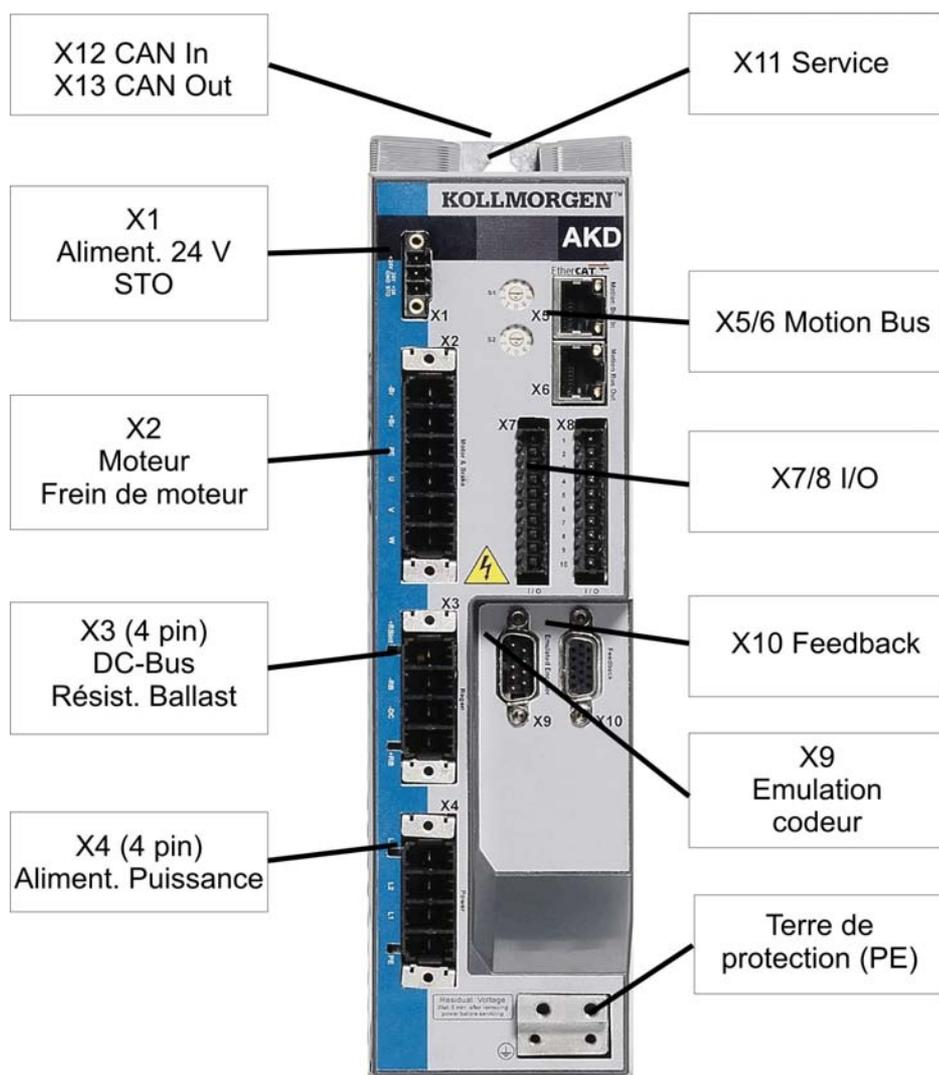
8.8 Schéma de raccordement, AKD-x00306 à x00606
