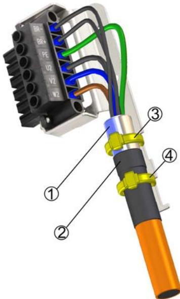
Retirez la gaine externe du câble sur environ 120 mm en veillant à ne pas endommager le blindage tressé. Remplacez le blindage tressé (1) sur le câble et sécurisez l'ensemble à l'aide d'un manchon en caoutchouc (2) ou d'un manchon rétractable.
