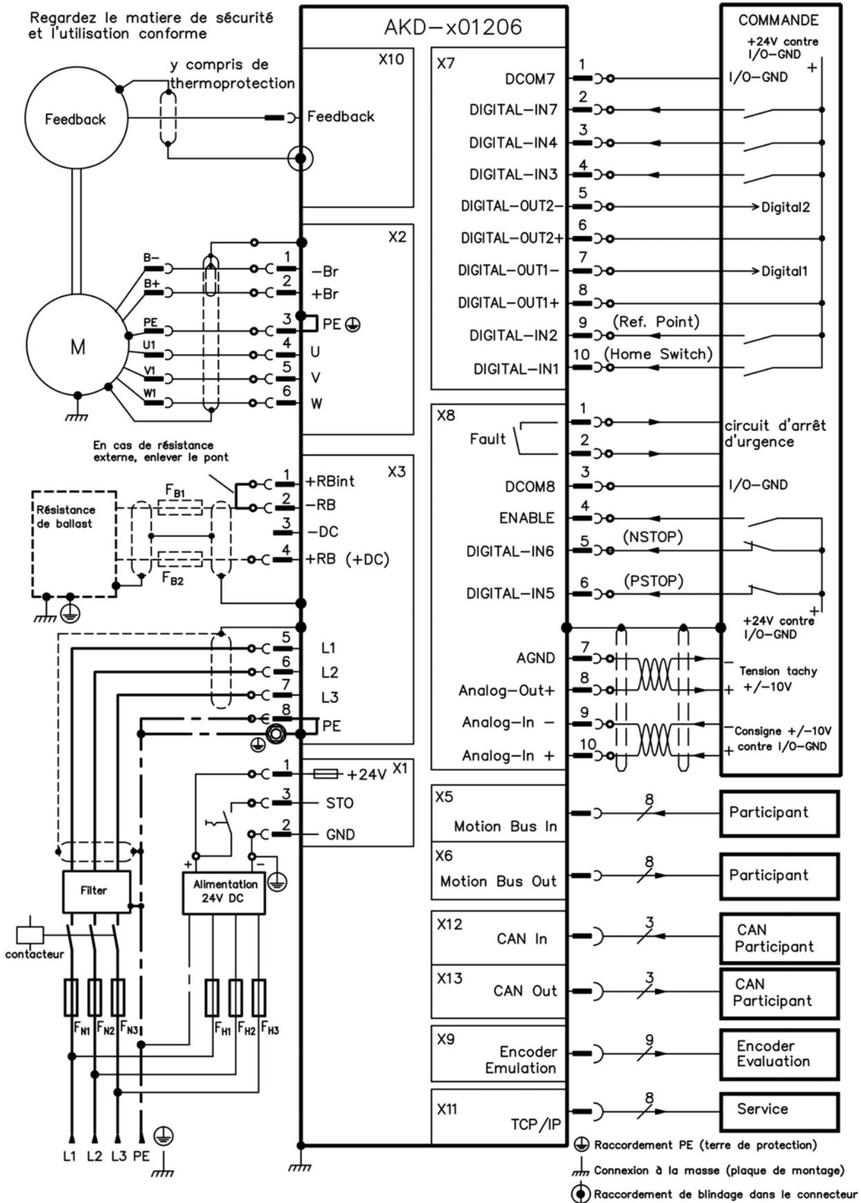
8.10 Schéma de raccordement, AKD-x02406 et AKD-xzzz07
