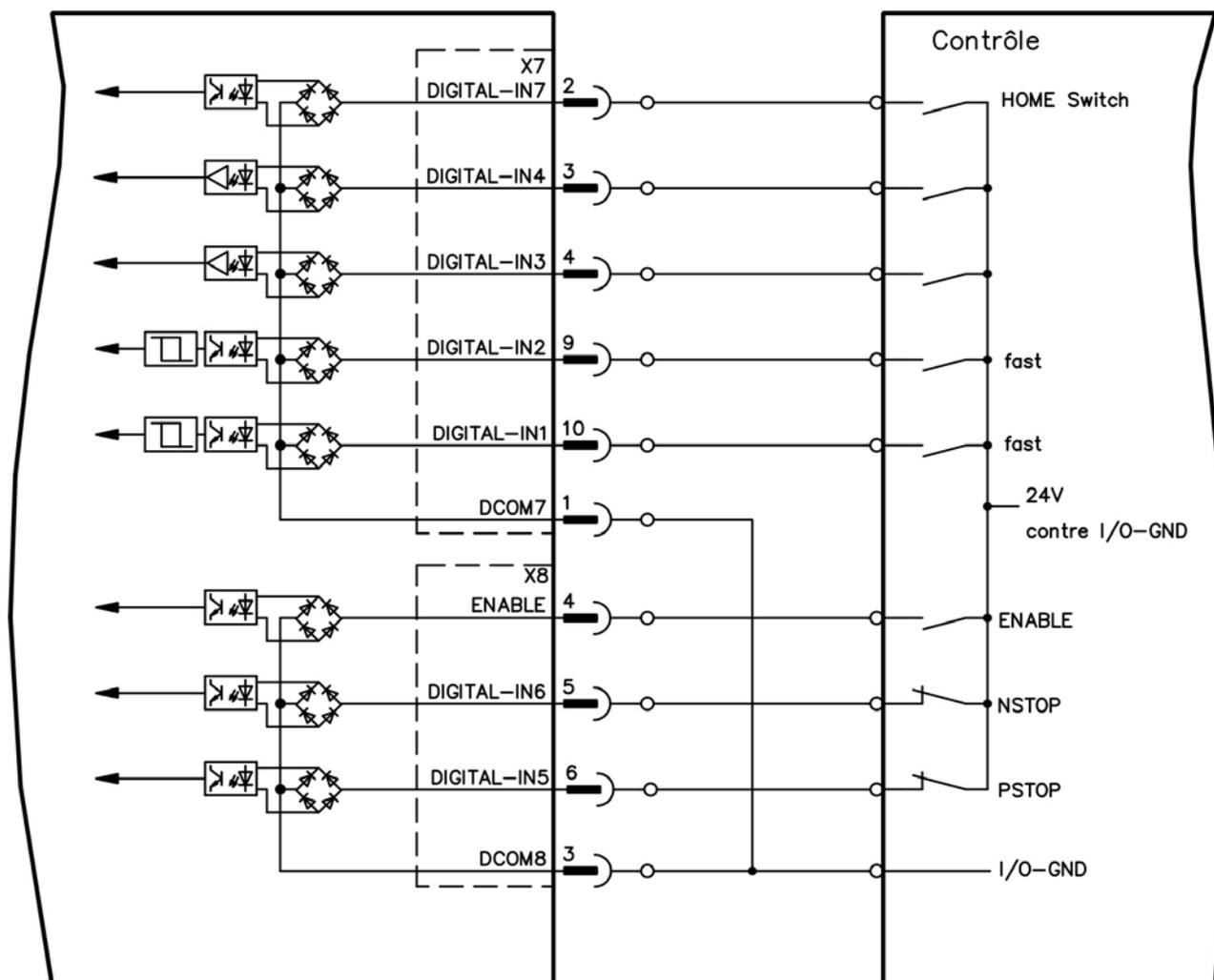
Schéma de câblage des entrées numériques (connexion de type Sink)
