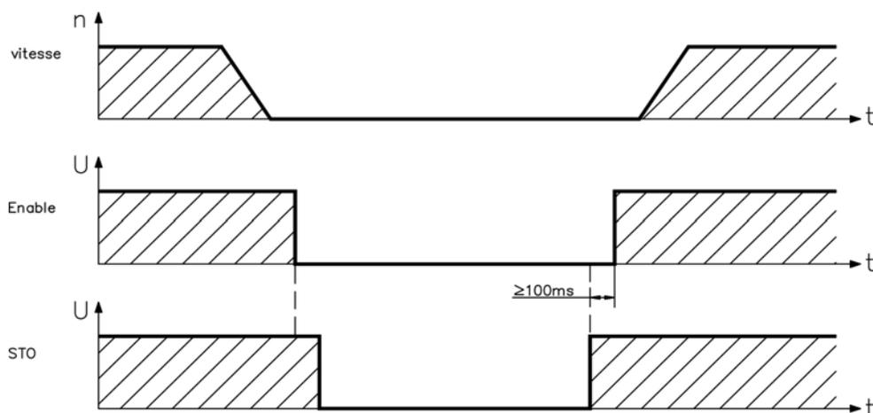
**⚠ AVERTISSEMENT** Les charges suspendues peuvent se mettre en mouvement sur les moteurs sans frein car le moteur perd tout couple au moment de l'enclenchement de la fonction STO de verrou de redémarrage. Utilisez des moteurs avec un frein intégré.
