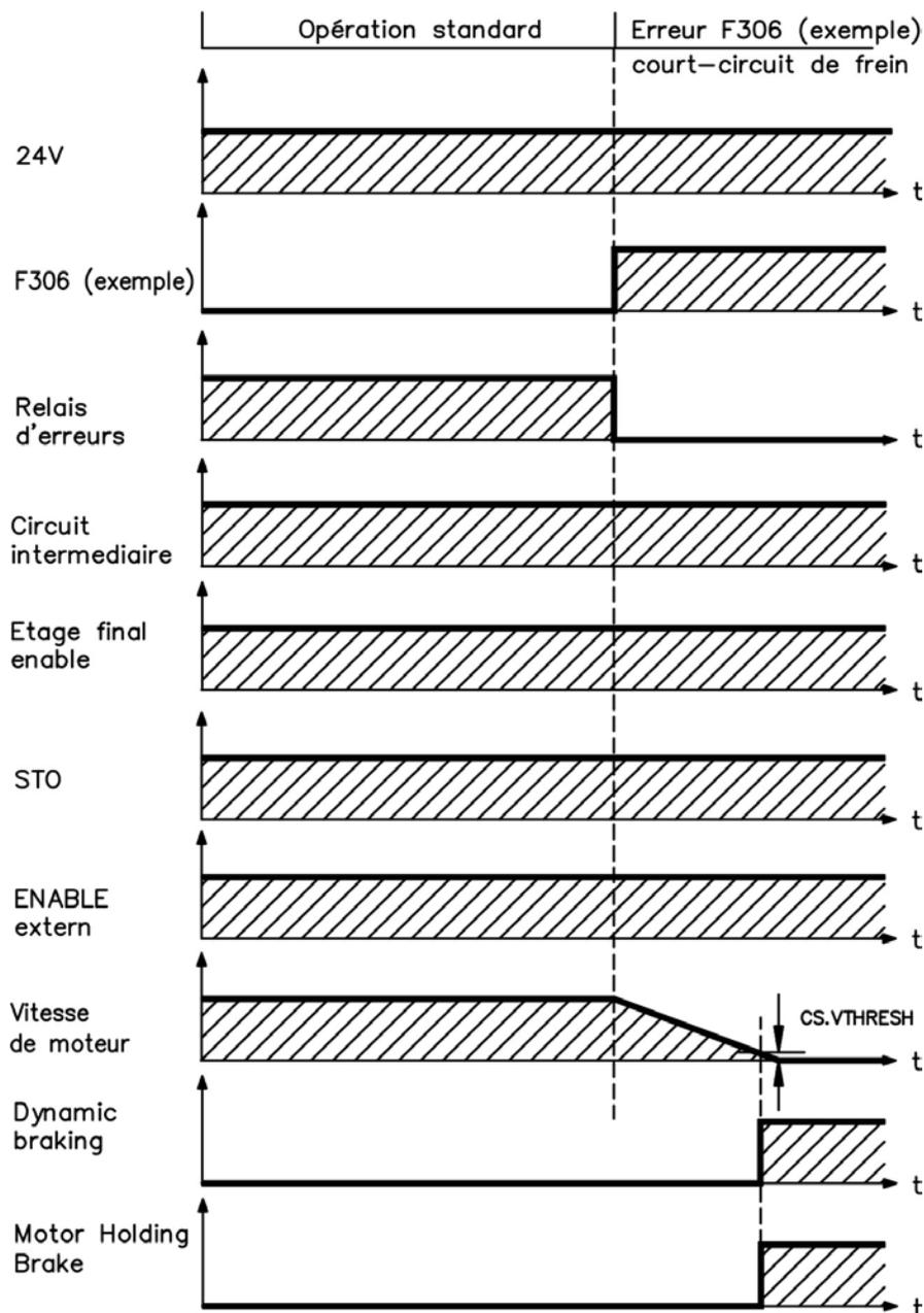
Si la vitesse chute en-deçà du seuil  $CS.VTHRESH$  ou si la temporisation intervient, le frein est fermé (=> p. 96).
