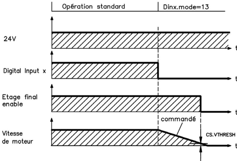
Si la vitesse chute en-deçà du seuil *CS.VTHRESH* ou si la temporisation intervient, le frein est fermé (=> p. 96).
