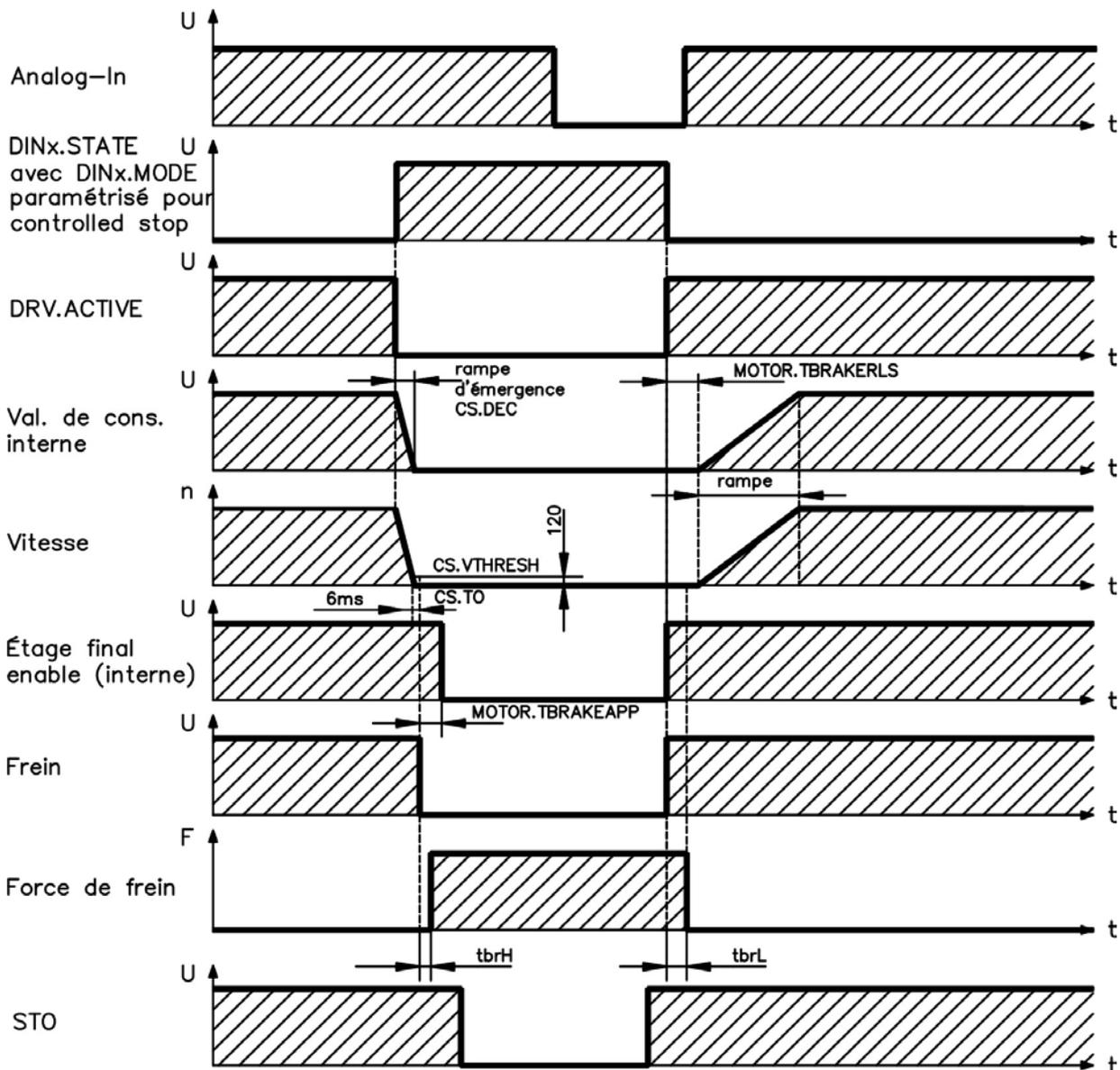
La valeur de consigne de vitesse du variateur est entraînée vers le bas sur une rampe réglable (CS.DEC) jusqu'à 0 V. Avec des valeurs standard la sortie du frein est mise sous tension lorsque la vitesse atteint 120 tr/min (CS.VTHRESH) pour au moins 6 ms (CS.TO). Les temps de montée ( $t_{brH}$ ) et de descente ( $t_{brL}$ ) du frein de maintien intégré au moteur varient en fonction du type de moteur (voir le manuel du moteur).
