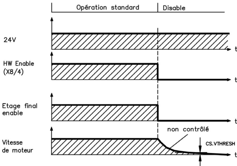
Si la vitesse chute en-deçà du seuil *CS.VTHRESH* ou si la temporisation intervient, le frein est fermé (=> p. 96).
