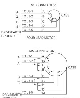
GROUND EIGHT LEAD MOTOR CONNECTED IN PARALLEL
