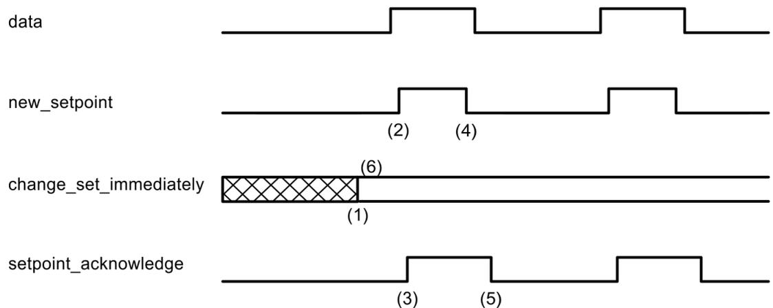
Die Abbildungen zeigen den Unterschied zwischen einer Folge von Sollwerten und einzelnen Sollwerten. Der Anfangsstatus des Bits „change\_set\_immediately“ im Steuerwort entscheidet über die verwendete Betriebsart. Zur Vereinfachung wurden nur Trapezbewegungen für die Beispiele verwendet.
