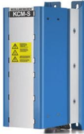
**KCM** Module (**K**OLL**M**OR**G**EN **C**apacitor **M**odules) nehmen kinetische Energie auf, die der Motor im generatorischen Betrieb erzeugt. Normalerweise wird diese Energie über Bremswiderstände in Verlustleistung umgesetzt. Die KCM Module speisen die gespeicherte Energie in den Zwischenkreis zurück, wenn sie benötigt wird.
