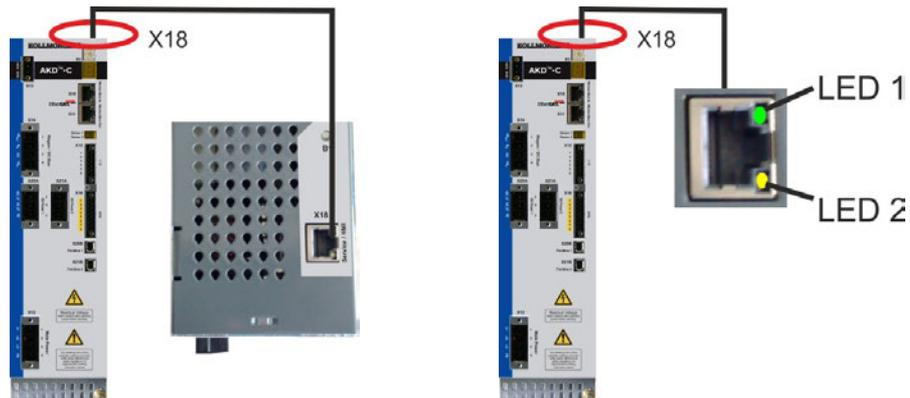
Schließen Sie die Serviceschnittstelle (X18) an eine Ethernet-Schnittstelle am PC direkt oder über einen Netzwerkschicht an. Das Kabel kann auch bei eingeschalteter Spannung gesteckt werden. Prüfen Sie, ob die Verbindungs-LEDs am AKD-C (grüne LED am RJ45-Stecker) und an Ihrem PC (oder Netzwerkschicht) beide leuchten. Wenn beide LEDs leuchten, besteht eine gute elektrische Verbindung.
