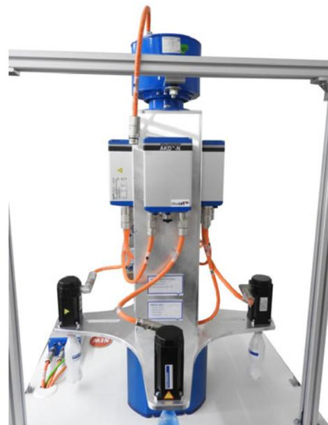
Der AKD-C wird über ein Hybridkabel CCNCN1 (max. 40m) am orangefarbenen Anschluss angeschlossen.
