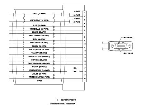
FIGURE B.15 J2 to No Connector Encoder Cable (P/N 401-34424-XX)
