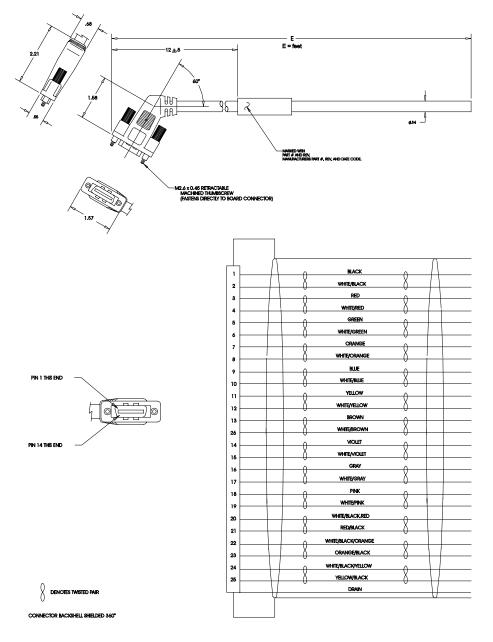
FIGURE B.3 J3 to No Connector Interface Cable (P/N 401-34410)
