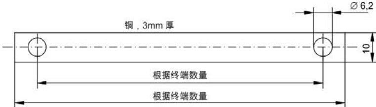
1. 从铜轨上切下所需长度的母线(横截面 10 x 3 mm)，并根据指示在其中钻孔。所需的所有屏蔽夹必须放置在钻孔之间。
