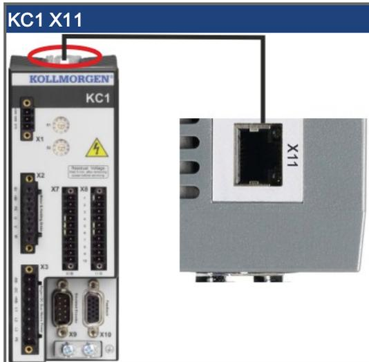
将驱动器的服务接口直接(或通过网络集线器/交换机)连接到 PC 上的以太网接口，与此同时，关闭设备电源。使用标准 Cat.5 以太网电缆进行连接(某些情况下，也可使用交叉电缆)。
