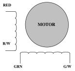
4 LEAD UNIFILAR MOTOR
