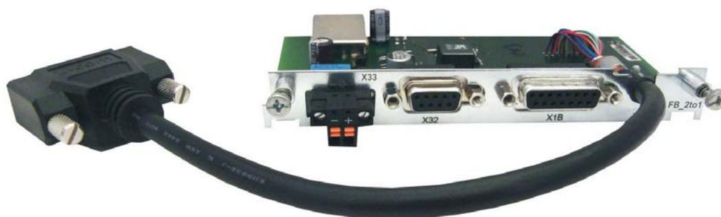
Il presente capitolo descrive la scheda di espansione per retroazione FB-2to1 per l'S700. La scheda consente il collegamento simultaneo di una retroazione digitale primaria e di una analogica secondaria al connettore X1. L'alimentazione con una tensione 24 V CC su X33 viene convertita nella scheda di espansione in un'alimentazione 5 V CC precisa del trasduttore per la retroazione secondaria.
