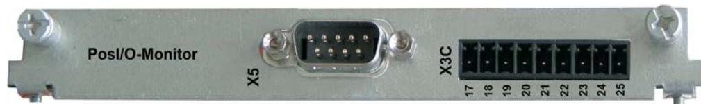
La scheda offre le caratteristiche della carta di Posl/O più un ulteriore connettore SubD X3C con ingressi/uscite analogici da +/-10V (pagina 146, capitolo "Ingressi/Uscite analogici"), la cui funzione è configurabile con il software di messa in funzione o funzioni macro.
