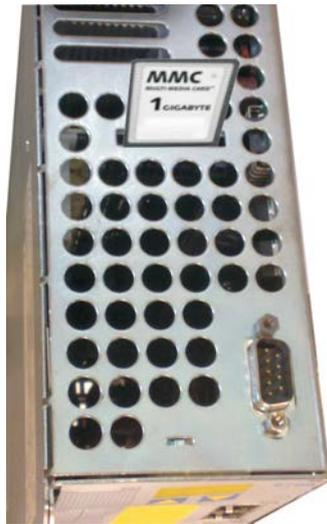
Nella parte superiore del servoamplificatore si trova un lettore per schede di memoria. Su queste schede è possibile memorizzare il firmware e un set di parametri completo (con i tasti di comando o il software di messa in funzione) da ricaricare sul servoamplificatore. Le carte MMC e SD sono sostenute.
