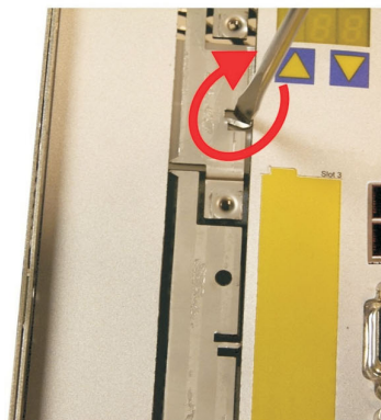
4 - Break the top rib
