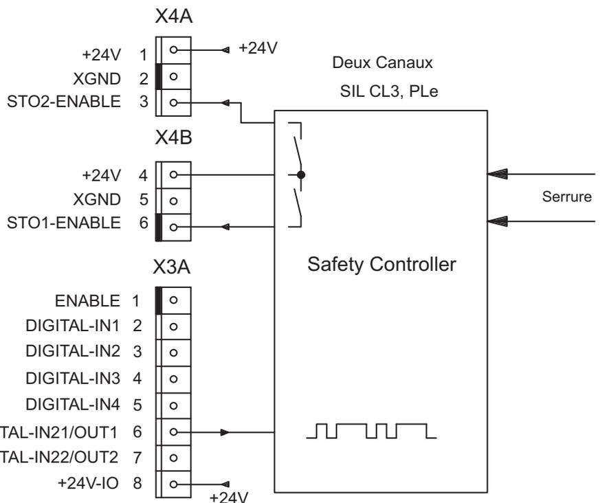
**INFORMATION** Pour atteindre SIL CL3 / PLe, l'état de commutation du blocage d'impulsions (état) est défini sur l'une des sorties numériques DIGITAL-OUT1 ou 2 (X3A/6 ou X3A/7) du variateur S700 à l'aide de la commande ASCII OxMODE 70.
