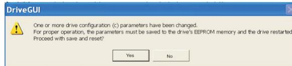
Cliquez sur Oui. Les paramètres sont automatiquement enregistrés dans l'EEPROM du variateur qui est redémarré via une commande de réinitialisation. Cette opération dure quelques secondes.
