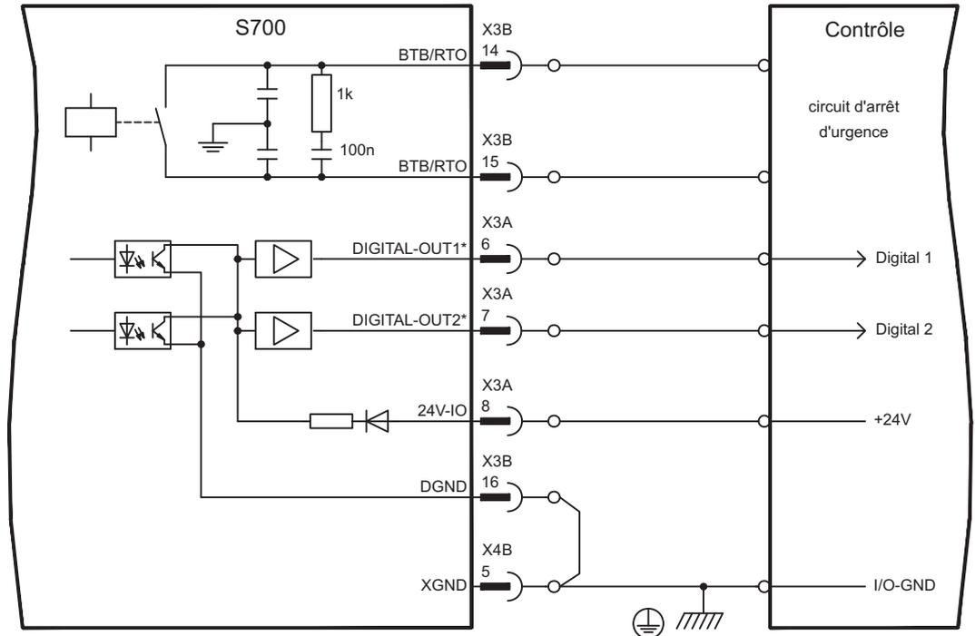
\* DIGITAL-OUT1 et 2 doivent être définies comme sorties à l'aide du logiciel de mise en service.
