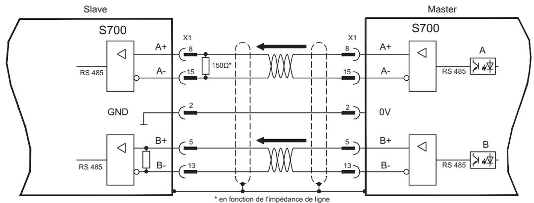
Si un SSI est utilisé comme émulation, le paramètre ENCMODE 10 doit être défini sur le maître et GEARMODE 25 sur l'esclave.
