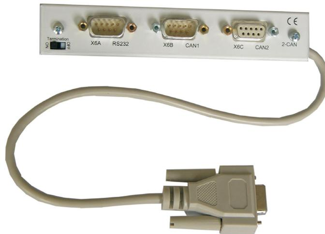
Le connecteur X6 du S700 transmet les signaux de l'interface RS232 et de l'interface CAN. L'affectation des broches des interfaces ne correspond donc pas à la norme et nécessite l'utilisation d'un câble spécial si les deux interfaces doivent être utilisées simultanément.
