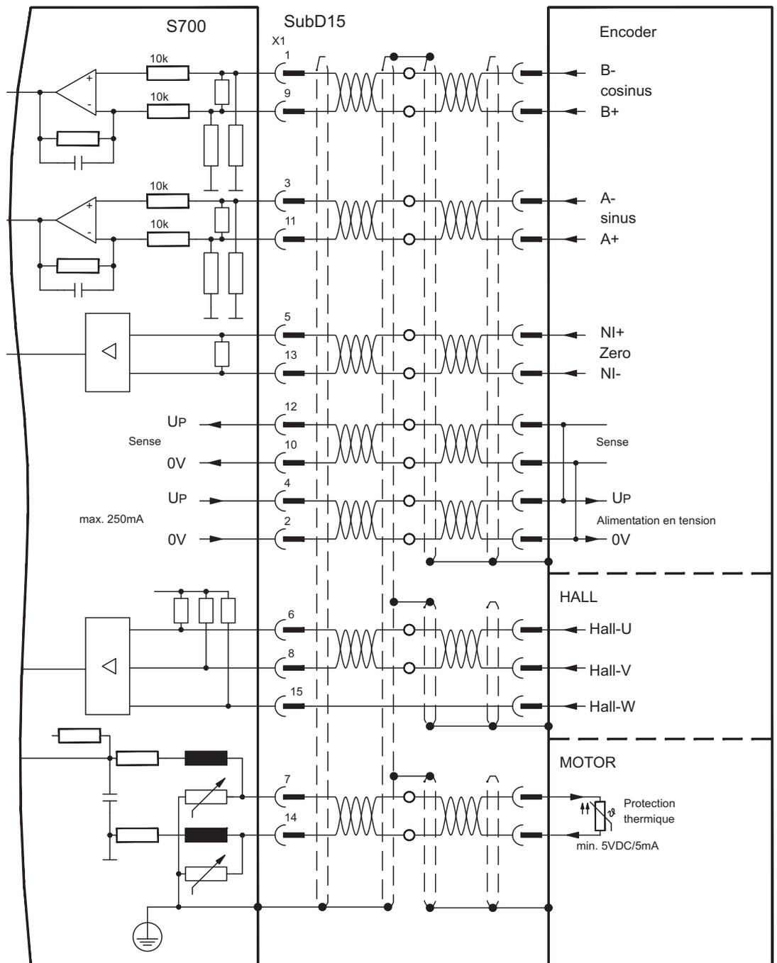
8.12.12 Codeur incrémentiel ROD (AquadB) 5V, 1,5MHz (X1)
