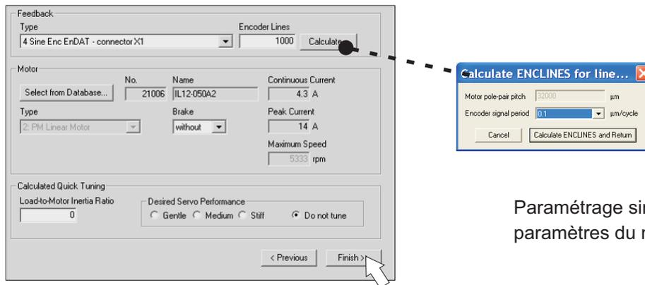
Paramétrage simplifié des paramètres du moteur.
