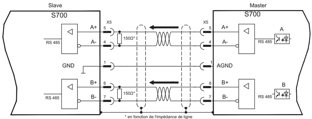
Si un SSI est utilisé comme émulation, le paramètre ENCMODE 2 doit être défini sur le maître et GEARMODE 5 sur l'esclave.
