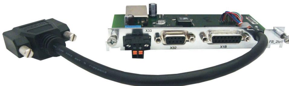
Ce chapitre décrit la carte d'expansion de rétroaction FB-2to1 pour le variateur S700. Cette carte permet de raccorder simultanément un système de feedback primaire numérique et un système de feedback secondaire analogique au connecteur X1. L'alimentation d'une tension auxiliaire de 24 V DC sur X33 est convertie sur la carte d'expansion en une alimentation de codeur précise de 5 V CC pour le feedback secondaire.
