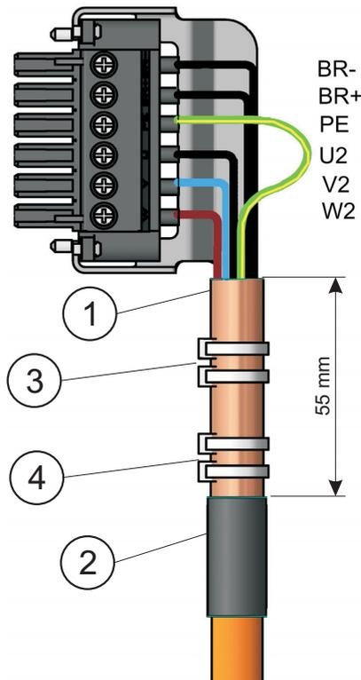
Retirez la gaine extérieure du câble sur une longueur d'env. 120 mm **sans endommager la tresse de blindage**. Enfilez la tresse de blindage (1) sur le câble en sens inverse et fixez-la à l'aide d'un passe-câble en caoutchouc (2) ou d'une gaine thermorétractable.
