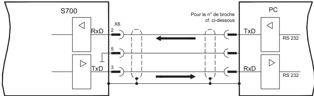
L'interface, isolée galvaniquement via des coupleurs optoélectriques, est placée au même potentiel que l'interface CANopen. L'interface est sélectionnée et réglée dans le logiciel setup. Vous trouvez d'autres indications page 108.
