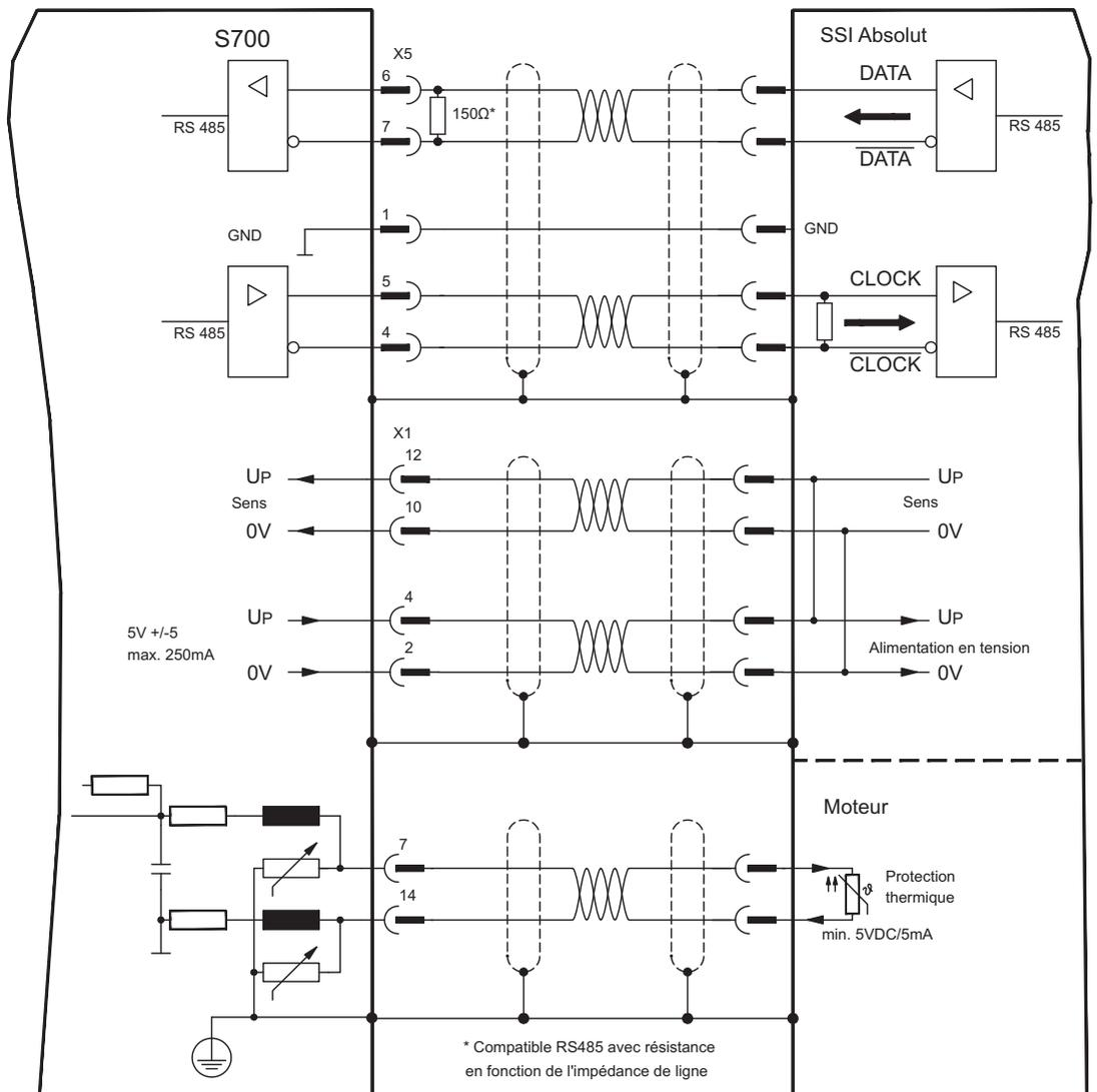
10.2.3.1.4 Codeur Sine avec SSI (X5, X1)
