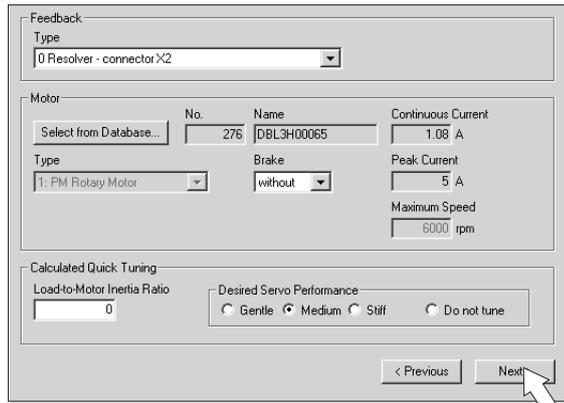
Paramétrage simplifié des paramètres du moteur.
