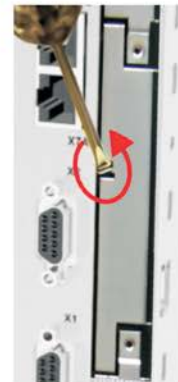
5 - Break the bottom rib
