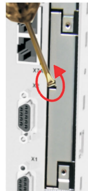
5 - Break the bottom rib
