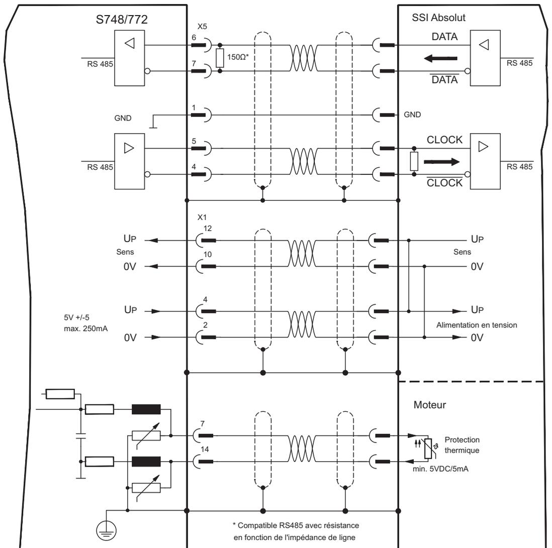
10.2.3.1.4 Codeur Sine avec SSI (X5, X1)
