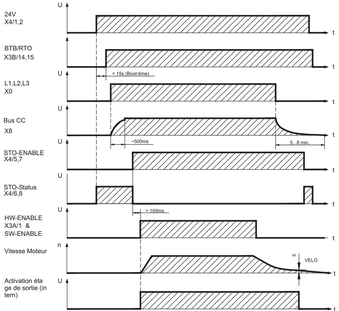
Les appareils avec sélection de la fonction "frein" (d'arrêt) disposent d'une procédure spéciale pour la mise hors service de l'étage final (⇒ p.30).
