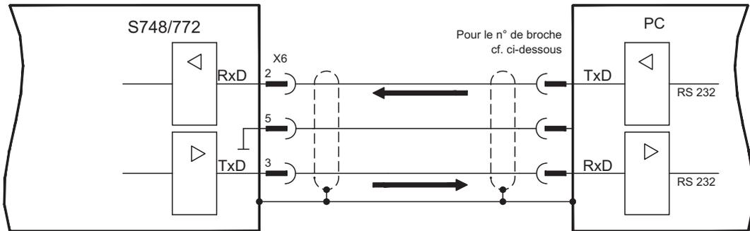
L'interface, isolée galvaniquement via des coupleurs optoélectriques, est placée au même potentiel que l'interface CANopen. L'interface est sélectionnée et réglée dans le logiciel setup. Vous trouvez d'autres indications page 106.
