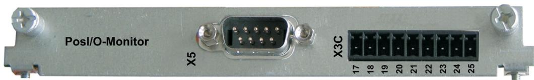
La carte d'expansion met à disposition outre X5, le connecteur mâle X3C avec entrées et sorties analogiques +/-10 V (reportez-vous à la page 148, chapitre "E/S analogiques"), dont les fonctions peuvent être configurées à l'aide du logiciel de mise en service ou de macrofonctions.
