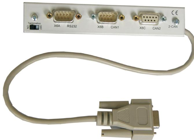
Le connecteur X6 du S748/772 transmet les signaux de l'interface RS232 et de l'interface CAN. L'affectation des broches des interfaces ne correspond donc pas à la norme et nécessite l'utilisation d'un câble spécial si les deux interfaces doivent être utilisées simultanément.
