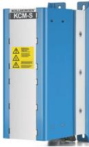
Les modules **KCM (KOLLMORGEN Capacitor Module)** absorbent l'énergie cinétique produite par le moteur en mode générateur. Normalement, cette énergie est transformée en puissance dissipée via les résistances de freinage. Les modules KCM réinjectent l'énergie stockée dans le circuit intermédiaire dès que c'est nécessaire. Dimensions (H x l x P): 300x100x201 mm
