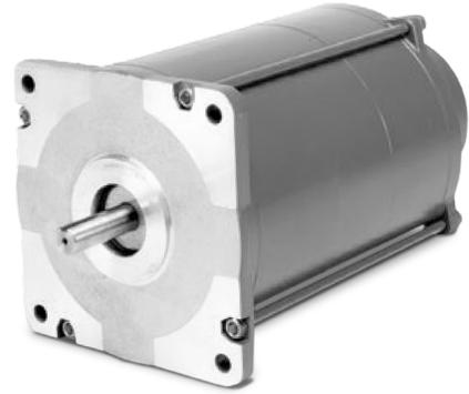
此款危险任务同步电机可提供高达 1500 oz-in (1059 N-cm) 的转矩，配有 NEMA 42 和 66 两种尺寸规格的框架 (110 mm 和 170 mm)。在 120 VAC 或 240 VAC、60 Hz 电源功率下，设备将以 72 rpm 的转速运行；在 240 VAC、50 Hz 电源功率下，设备将以 60 rpm 的转速运行。
