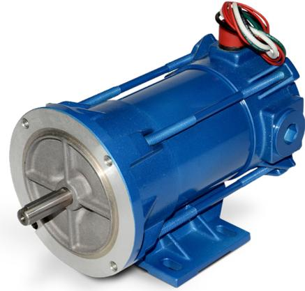
PMDC EP (防爆) 电机为有刷永磁直流电机, 用于需要固定速度和恒定负载的情况。提供 NEMA 56C 框架尺寸, 采用 TENV (全封闭, 不通风) 配置, 电源电压范围为 1/4 至 3/4 hp。
