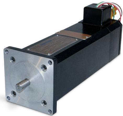
Goldline EB 和 EBH 伺服电机具有出色的转矩密度和极高转速。EB 系列的适用电压范围最高可达 230 VAC，而 EBH 系列具有高达 480 VAC 的更高电压范围。两大系列的转速最高可达 7500 rpm。此类电机包含坚固的旋变反馈，内置恒温器和 F 级绝缘层。非常适合用于需要高度动态运动（包括可变速度和可变负载）的情况，以及易燃蒸气或气体易造成潜在危险环境的场所。
