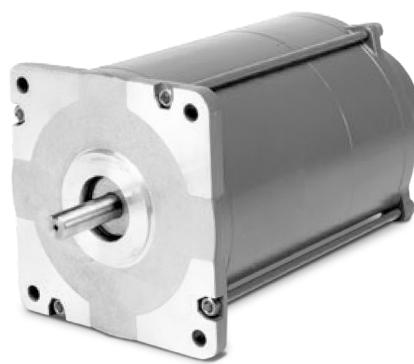
此款危险任务同步电机可提供高达 1500 oz-in (1059 N-cm) 的转矩，配有 NEMA 42 和 66 两种尺寸规格的框架 (110 mm 和 170 mm)。在 120 VAC 或 240 VAC、60 Hz 电源功率下，设备将以 72 rpm 的转速运行；在 240 VAC、50 Hz 电源功率下，设备将以 60 rpm 的转速运行。
