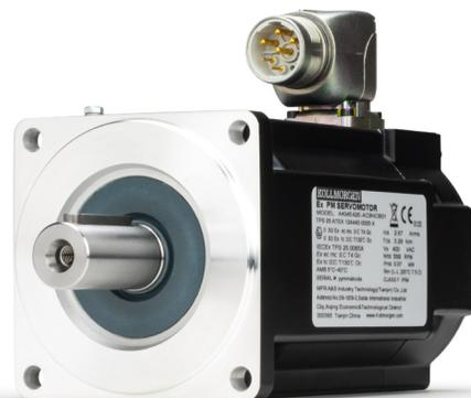
AKME 危险场所专用伺服电机基于久经考验的 AKM 伺服电机平台打造, 通过增强设计特性, 成功取得 ATEX 与 IECEX 认证, 适用于气体与粉尘环境的 2 区及 22 区爆炸性危险场所。为满足多样化应用需求, 该系列电机提供 2-7 号框架尺寸, 可配合 48, 75 Vdc、120、240 或 400 Vac 驱动器工作, 转速最高可达 5,000 rpm, 并且配备了完整的绝对反馈定位装置。
