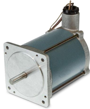
MX 防爆系列步进电机的框架尺寸为 NEMA 34 和 42 (90 和 110 mm)。此款电机每转 200 步进(1.8° 步进角), 可提供 1.27 至 9.82 N·m (180 至 1,390 oz-in) 的最小保持转矩。
