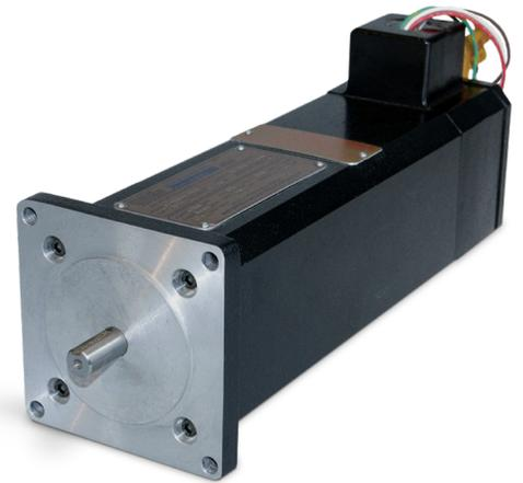
Goldline EB 和 EBH 伺服电机具有出色的转矩密度和极高转速。EB 系列的适用电压范围最高可达 230 VAC, 而 EBH 系列具有高达 480 VAC 的更高电压范围。两大系列的转速最高可达 7500 rpm。此类电机包含坚固的旋变反馈, 内置恒温器和 F 级绝缘层。非常适合用于需要高度动态运动 (包括可变速度和可变负载) 的情况, 以及易燃蒸气或气体易造成潜在危险环境的场所。
