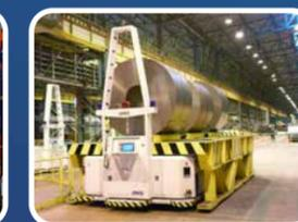
2009年为韩国浦项钢铁公司制造了全球第一辆带有16个受控轮的无人驾驶车。
